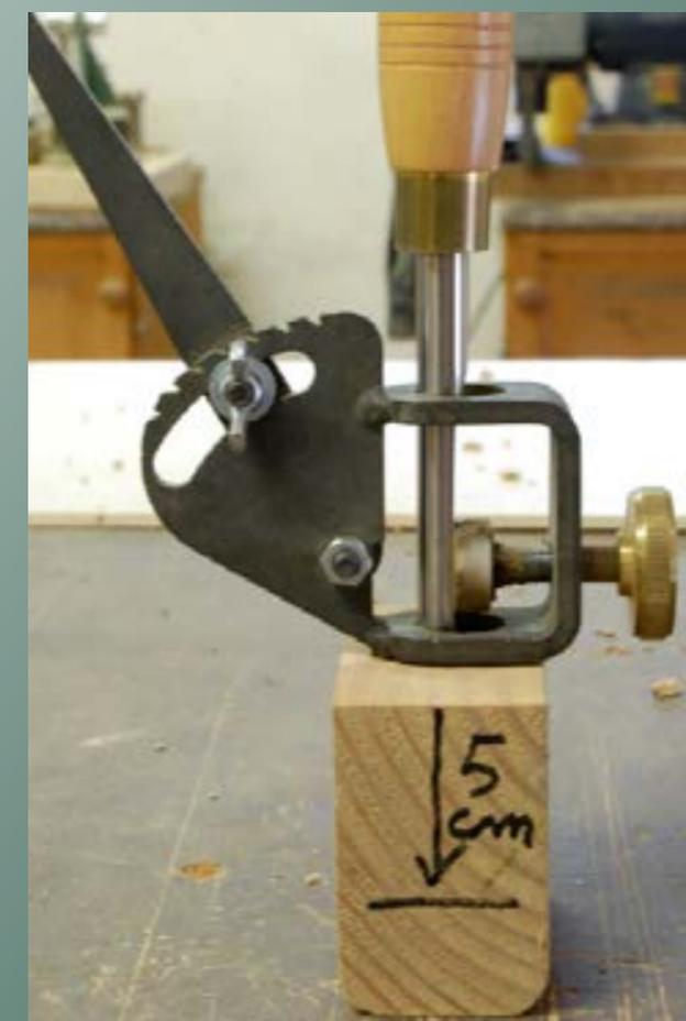
Un blocchetto di legno, con un foro (diametro 20 mm.) in cui infilare la sgorbia, con una precisa profondità; serve a far sì che la quantità di sgorbia che fuoriesce dal jig sia sempre uguale, indipendentemente da quanto è lunga la sgorbia. Questo fatto vi permette di settare velocemente il jig negli altri due parametri, in-
