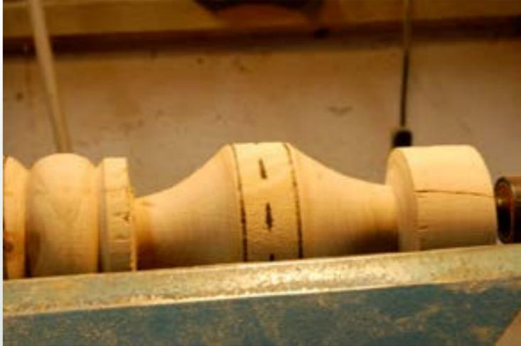
*E poi andremo a raccordare il "gambo" con la parete del toro,usando praticamente il taglio che fareste con una sgorbia da grosso (di cui ormai siete padroni ) solo in piccolo...con la vostra sgorbia per profilare,riducendo il diametro:*
