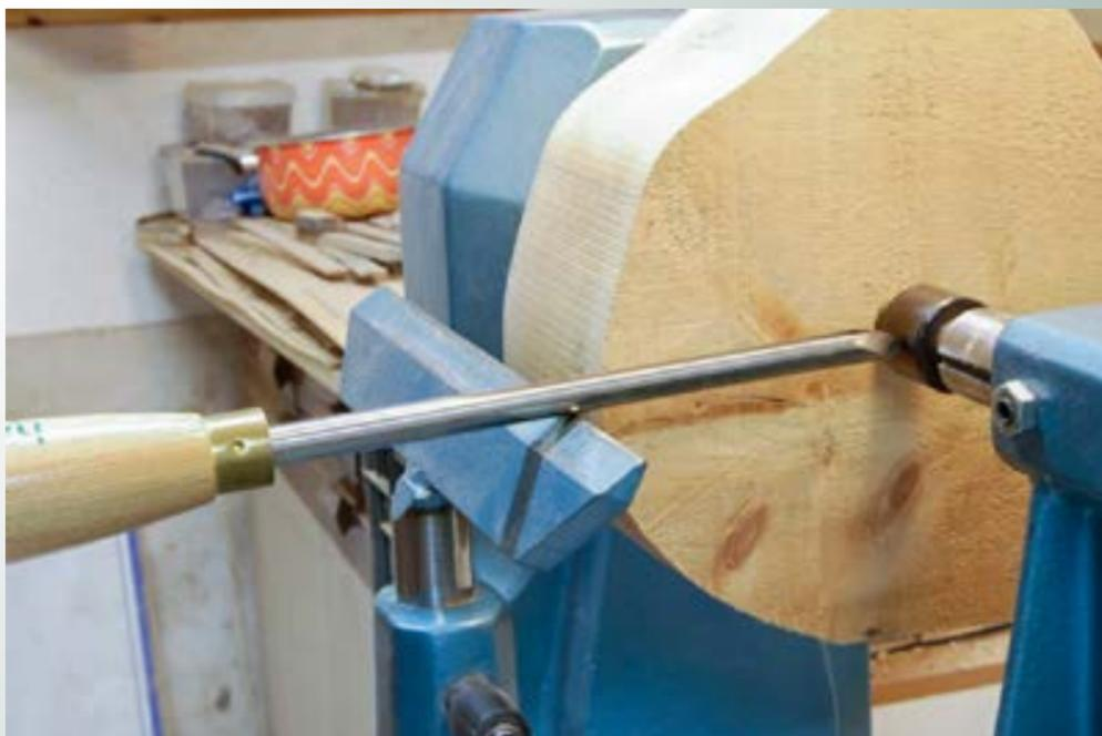
Siamo pronti per iniziare la tornitura; la prima operazione sarà volta a regolarizzare il diametro del legno: avremo così una rotazione senza vibrazioni inutili che disturberebbero la nostra azione di taglio e che sottoporrebbero a stress inutili il nostro tornio (soprattutto con torni medio-piccoli).
