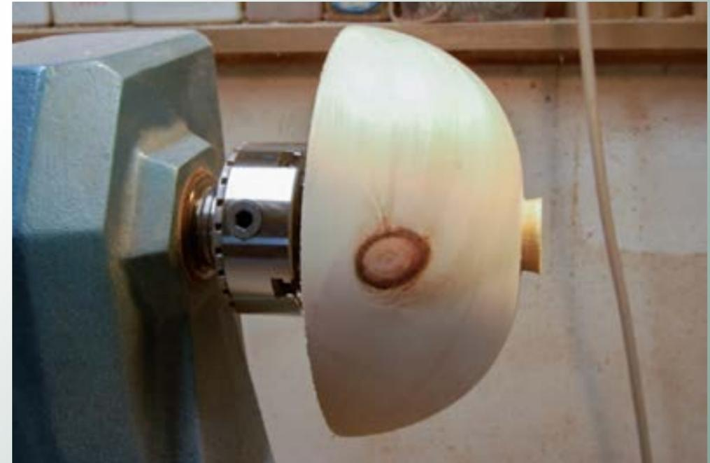
Con la nostra presa efficacemente stretta nelle griffe del mandrino, la prima operazione da eseguire è la spianatura della superficie dove andremo poi ad eseguire lo scavo; oltre ad evitare che i bordi della ciotola siano irregolari, questa tornitura "pulisce" la superficie, permettendoci di vedere eventuali imperfezioni, crepe, etc e ancora una volta favorirà un miglior equilibrio dinamico (da ricercare sempre: tornire non vuol dire fare a cazzotti con un tornio imbizzarrito )
