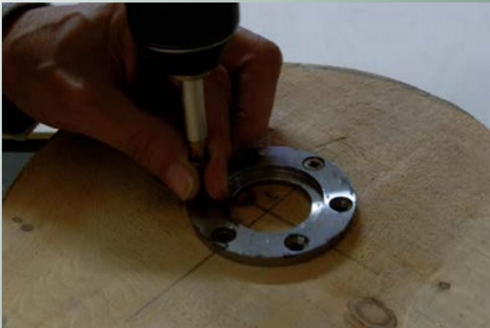
Dopo aver affilato la sgorbia,passiamo al montaggio del legno sul tornio;potremmo usare il platorello oppure l'anello. Data la massa importante e la scarsa tenuta del legno (Pino),da evitare la coda di porco.
