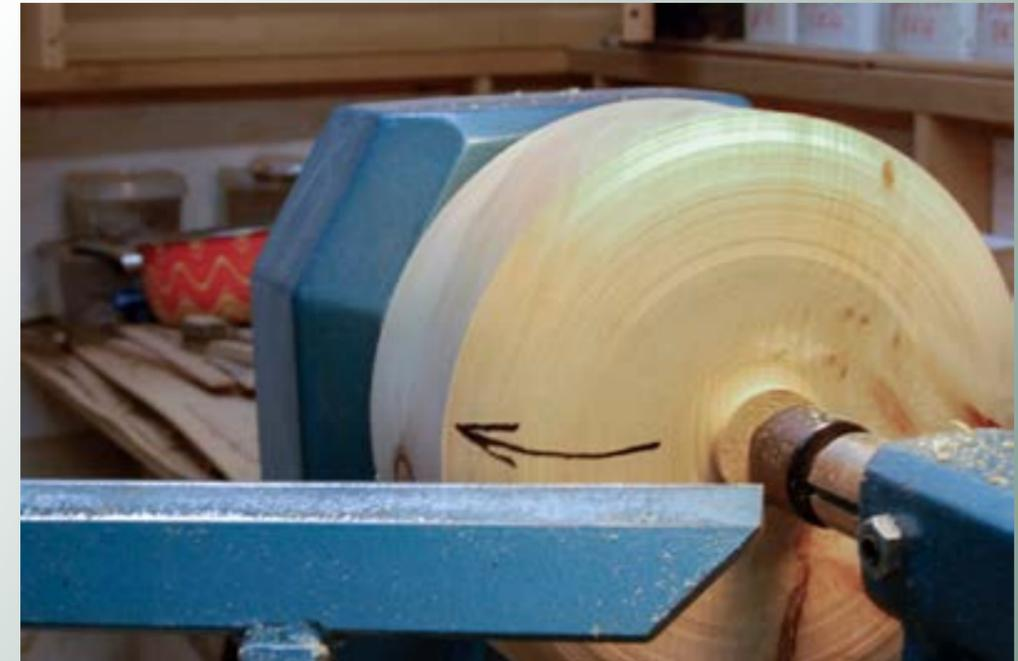
Via via "arrotondando", cercando di ottenere una passata continua, con spessore ben controllato, creando una linea fluida e continua
