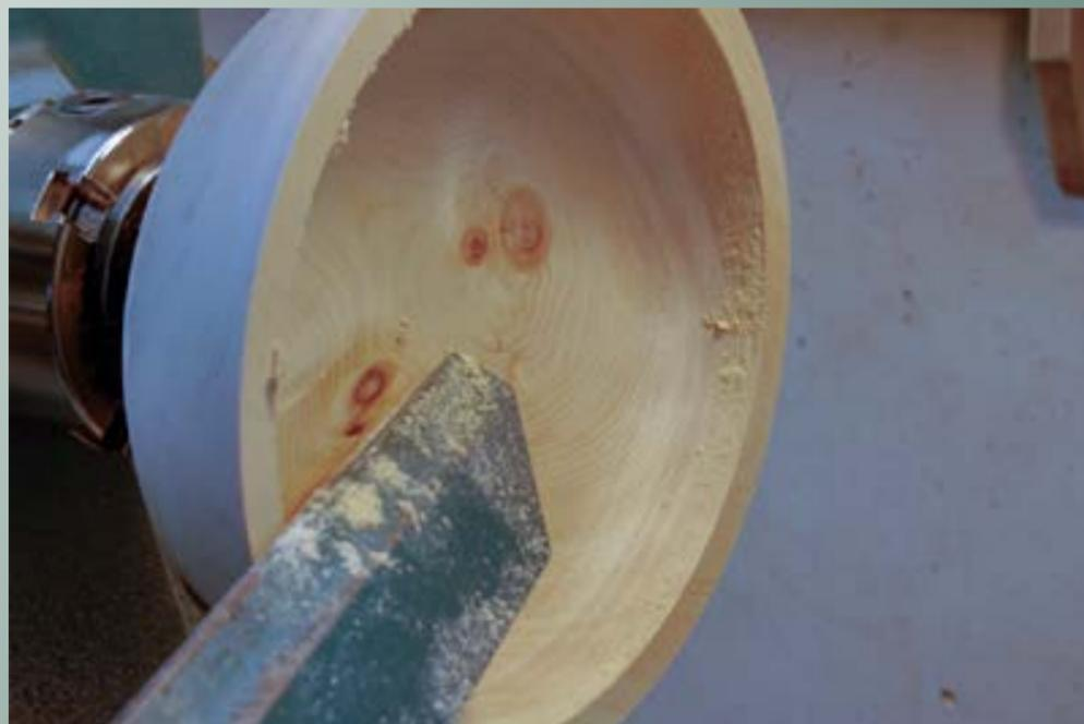
Ed eccoci a fine scavo (ricordate mentre procedete, di controllare lo spessore della parete per far sì che sia regolare; non è solo un problema estetico: le tensioni delle fibre si distribuiranno meglio in uno strato uniforme)
