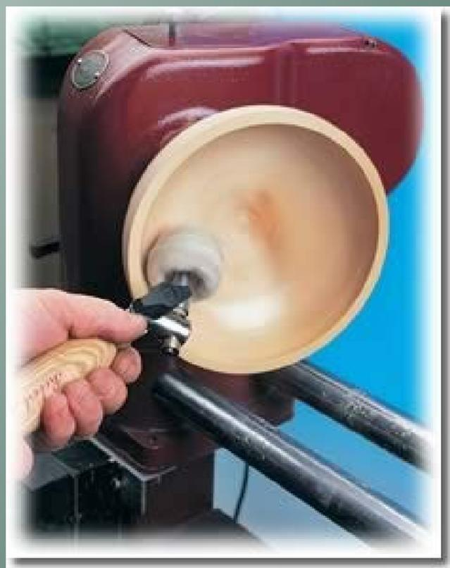
Nella seconda immagine, oltre a dove applicare l'utensile, potete vedere anche un uso estensivo: al posto del tampone velcrato per l'abrasivo, vedete in azione un tampone per lucidare.
